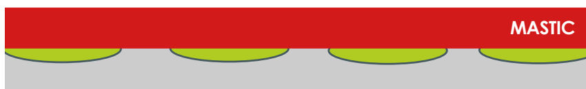
Fig. 2b Huile, graisse à la surface – mauvais contact.
