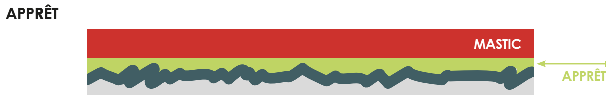
Fig. 1d Surface avec une couche d'apprêt – bon contact.
