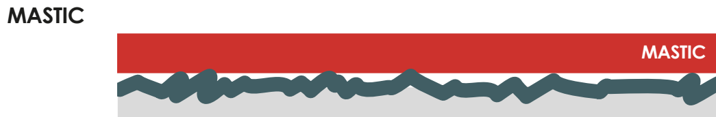
Fig. 1c Surface rugueuse – mauvais contact.
