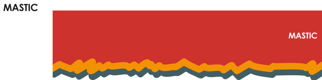
Fig. 1b Surface régulière (agrandie) – bon contact.
