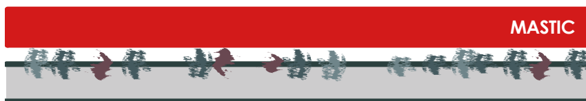
Fig. 2a Saleté, poussière, vieux mastic à la surface – mauvais contact.
