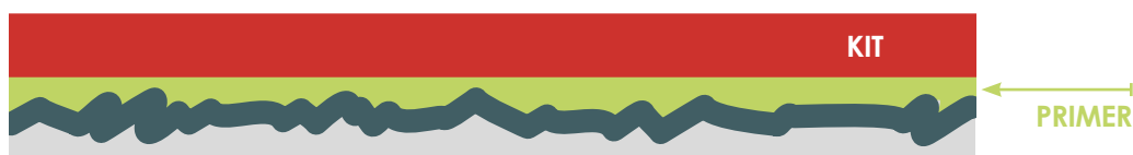
Afb. 1d Oppervlak met een primerlaag - goed contact.
